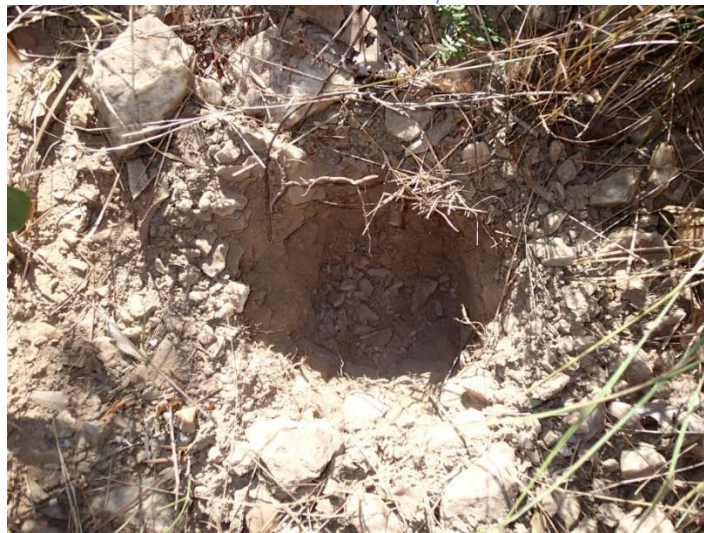
FIG. 94. VISTA SUPERIOR DE PERFURAÇÃO COM SAPRÓLITOS APARECENDO DESDE O COMEÇO DESSA, PONTO CMC_21_39 (FOTO: RENATA ESTEVAM).
